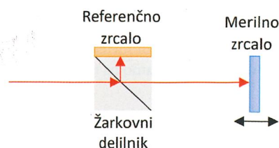
» Slika 2: Senzorska glava merilnega sistema z žarkovnim delilnikom.
